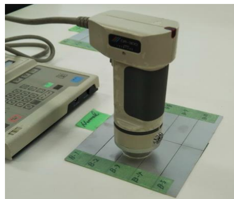
図2 色彩色差計による測定
