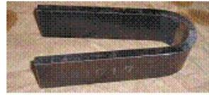
図3 曲げ試験後の試験片
