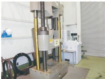
図1 万能試験機による引張試験
