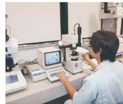
図5 ビッカース硬さ試験状況
