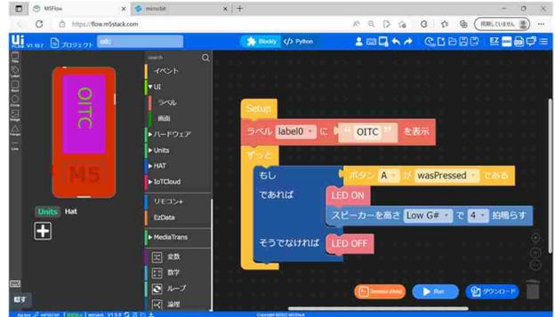
図2 UIFlow を用いたプログラム開発と日本語表示で開発を行うため初心者優しい設計となっています(図2)。
