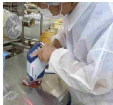
図6 現場でのハンドヘルド蛍光 X 線分析装置による異物分析の様子
