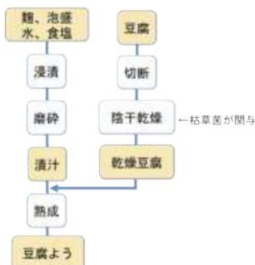
図1 豆腐よりの製造工程
