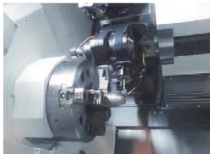
ミル軸による穴あけ加工
