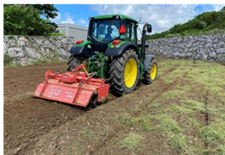
ロータリーによるすき込み ※浅めにすき込みます
