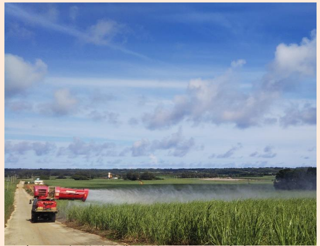
写真2. 大型送風散布機を用いた防除
