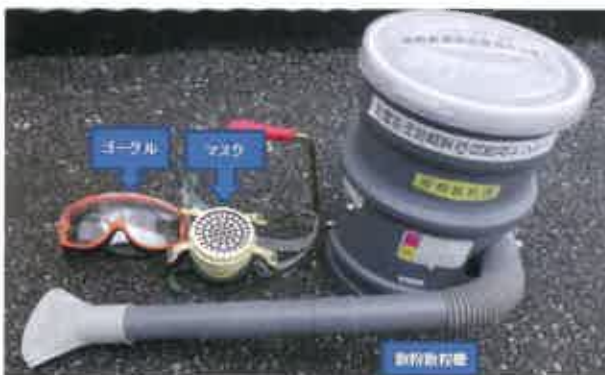
写真2. 硫黄粉剤散布機材（散粉散粒機、ゴーグル、マスク）
