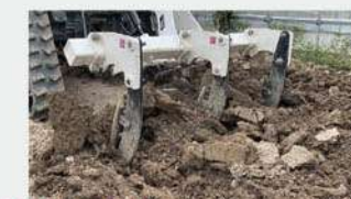
排土型 心土破碎機 例：プラソイラ
