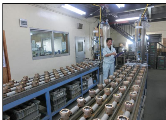
水道メーター検定の様子
