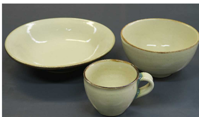
図2 化粧用原料を使用した試作品の外観
