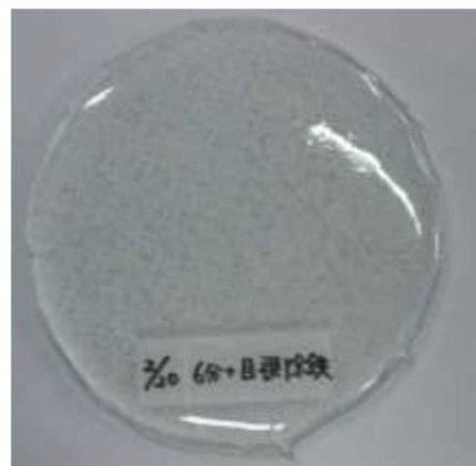
図2 金属片混入ガラス溶融物(除鉄後)
