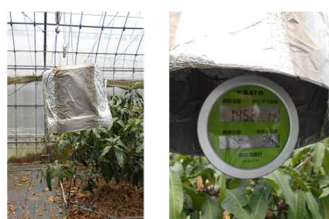
図4 積算温度計の設置状況
