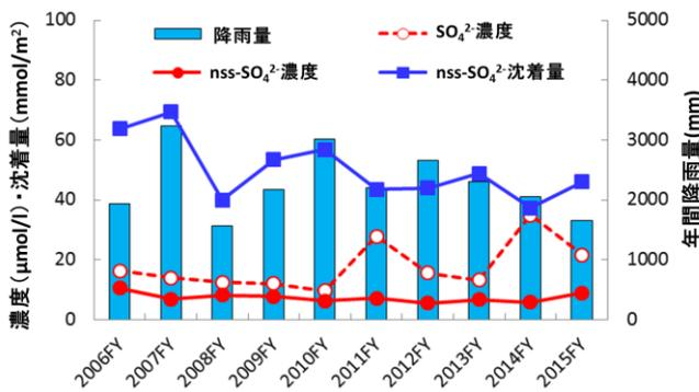
図 2. SO<sub>4</sub><sup>2-</sup>(wet) 濃度, nss-SO<sub>4</sub><sup>2-</sup>(wet) 濃度および nss-SO<sub>4</sub><sup>2-</sup>(wet) 沈着量の年平均値と年間降雨量の経年変動. SO<sub>4</sub><sup>2-</sup>(wet) 濃度は海塩の影響により大きく変動し, nss-SO<sub>4</sub><sup>2-</sup>(wet) 濃度はほぼ横ばいで推移した. nss-SO<sub>4</sub><sup>2-</sup>(wet) 沈着量は年間降雨量の増減と類似した挙動を示しながら, やや減少傾向を示した.
