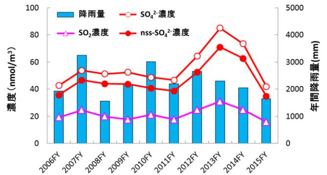
図 3. SO<sub>4</sub><sup>2-</sup>(p) 濃度, nss-SO<sub>4</sub><sup>2-</sup>(p) 濃度および SO<sub>2</sub>(g) 濃度の年平均値と年間降雨量の経年変動. SO<sub>4</sub><sup>2-</sup>(p) 濃度, nss-SO<sub>4</sub><sup>2-</sup>(p) 濃度および SO<sub>2</sub>(g) 濃度は同様の挙動を示し, 年間降雨量との相関は認められなかった.
