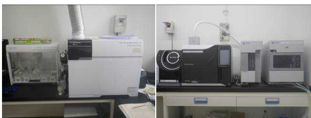
写真2. 金属類を測定するICP-MS（左）、揮発性有機化合物を測定するP&T-GC/MS（右）
