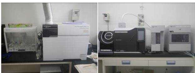
写真2. 金属類を測定するICP-MS（左）、揮発性有機化合物を測定するP&T-GC/MS（右）
