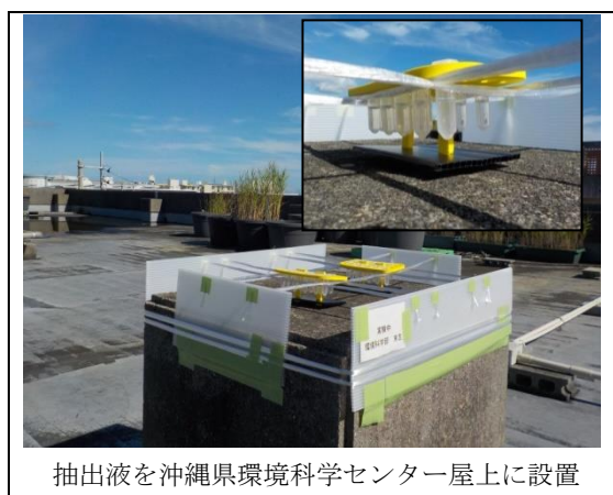
図 2-3_5 太陽光による変性の確認方法
