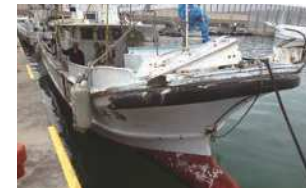
漁船破損状況
