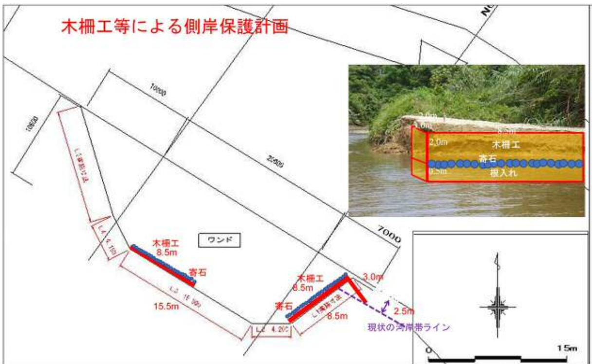
図 1.1.1-3 ワンド施設改良計画平面図
