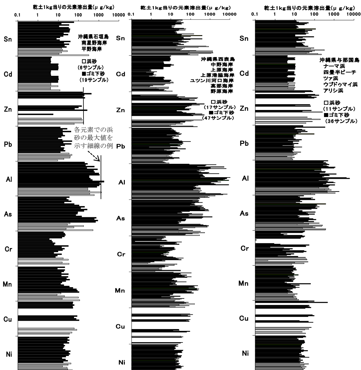
図VII.1(a) 沖縄島嶼海岸域で採取したゴミ下砂からの重金属類等の溶出状況
