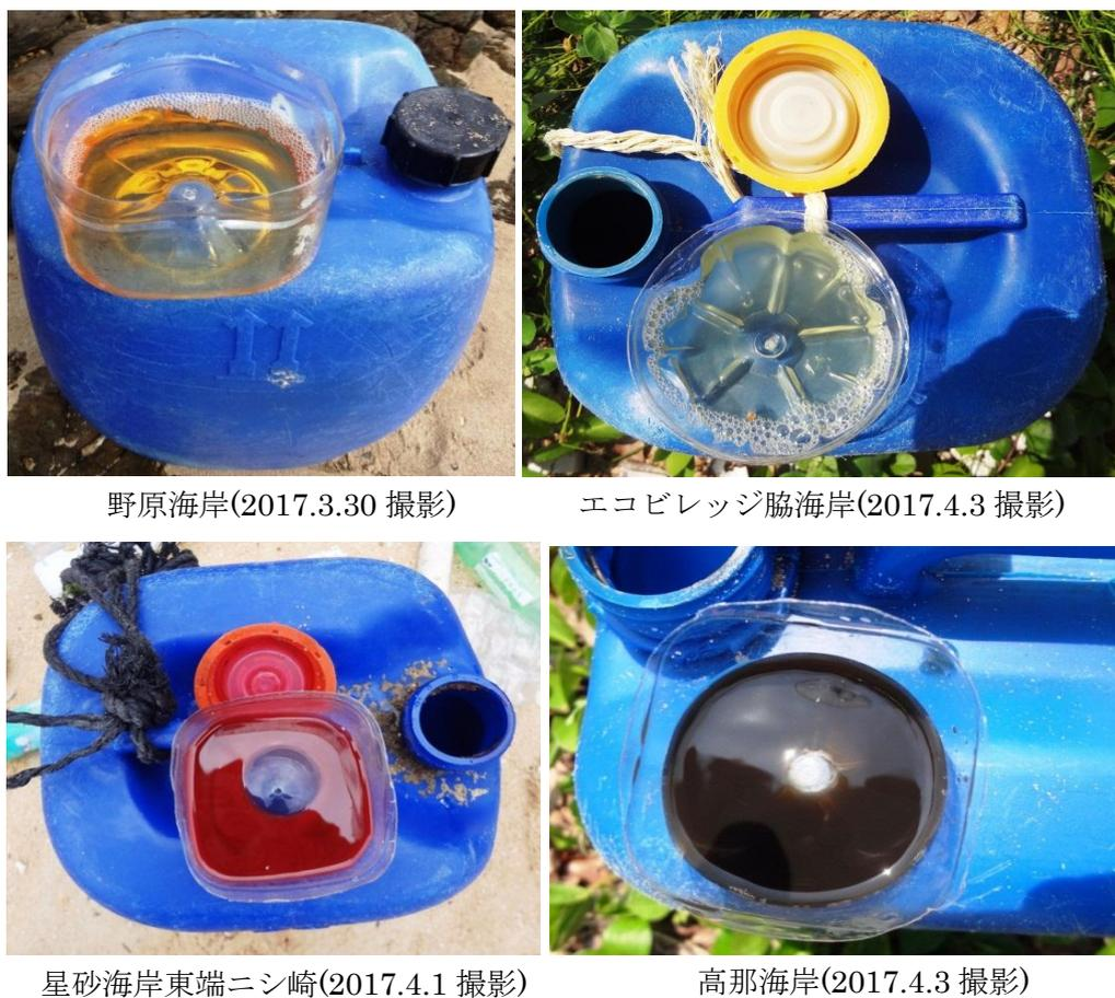
写真IV.1 7 縄西表島で漂着確認した韓国製廃ポリタンク内の残存液体の事例(2017年春季調査)
