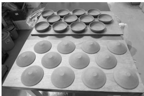
図4 機械ロクロ成形したテストピース
