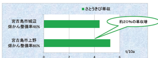
かんがい施設による効果(H25年干ばつ時) ①H25年干ばつ時 さとうきび単収(株だし)
