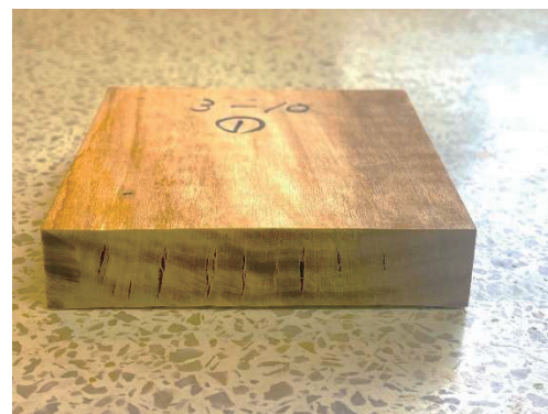
図-5 各損傷の程度 (上：表面割れ、下：内部割れ)
