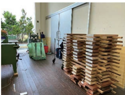
図-3 天然乾燥試験の栈積み状況
