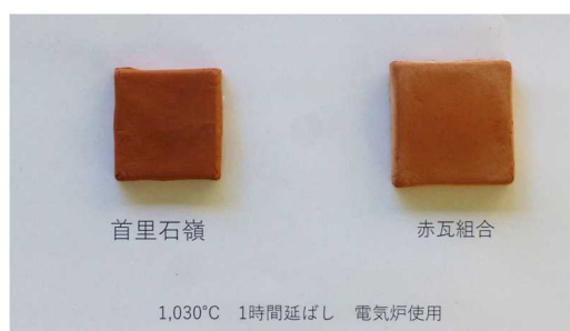
図1 石嶺クチャと赤瓦組合クチャ焼成体
