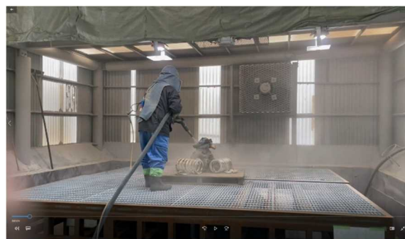
図6 ブラスト回収装置を使用した作業状況
