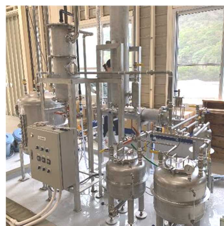
図2 製作した減圧蒸留機
