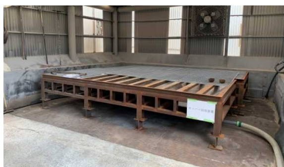
図5 製作した使用済みブラスト材回収装置
