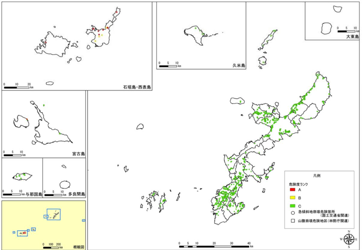
図 2.2-5(24) 石垣島スラブ内地震の斜面崩壊危険度ランク分布
