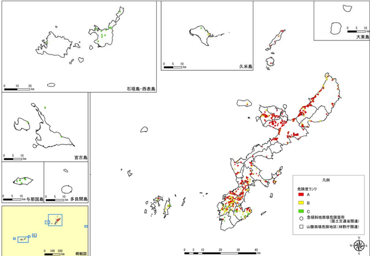
図 2.2-5(22) 沖縄本島北部スラブ内地震の斜面崩壊危険度ランク分布
