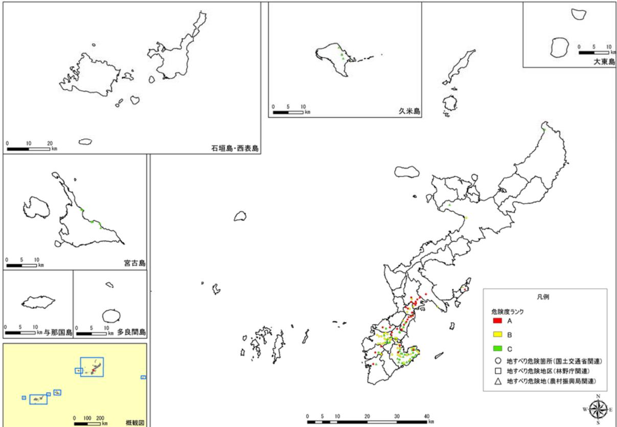
図 2.2-6(3) 石川-具志川断層系による地震の地すべり危険度ランク分布
