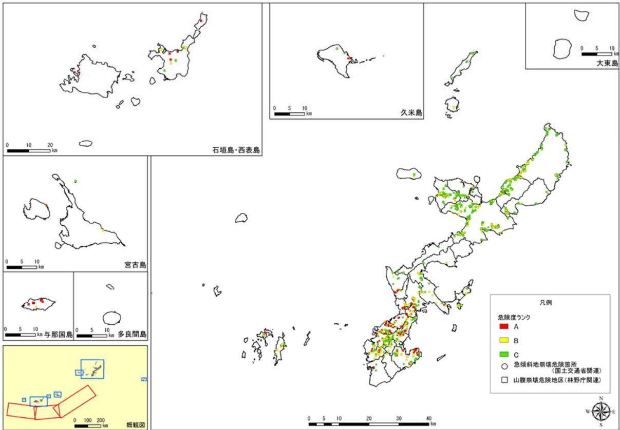
図 2.2-5(21) 八重山諸島南方沖地震3連動の斜面崩壊危険度ランク分布
