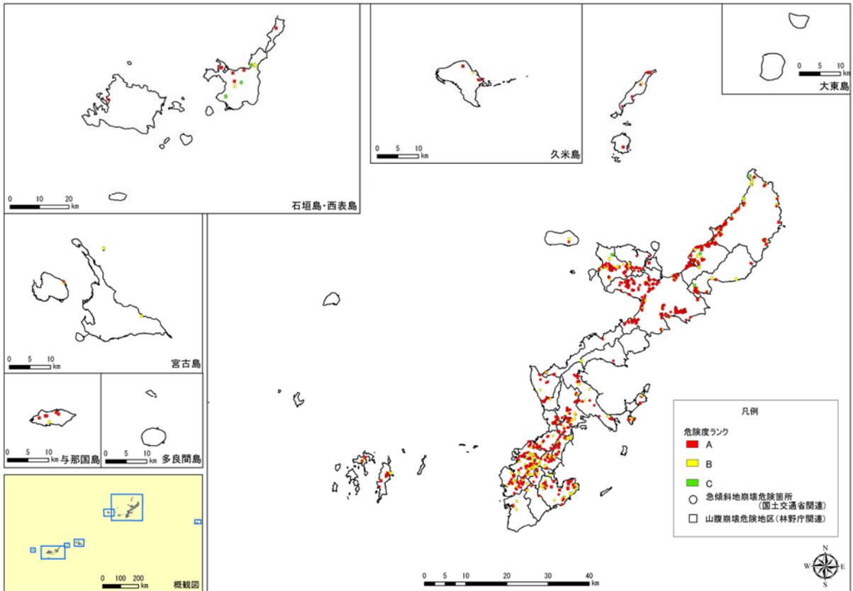
図 2.2-5(25) 一律地震動による地震の斜面崩壊危険度ランク分布
