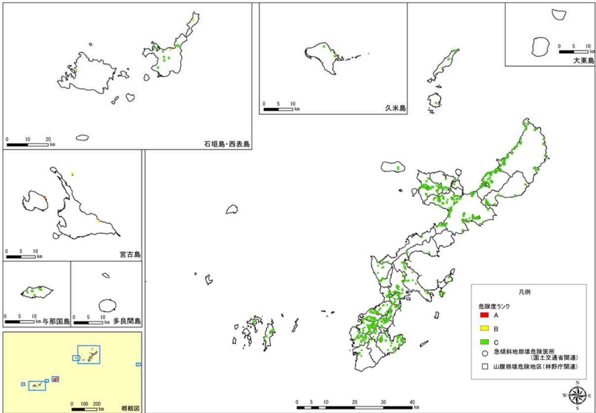
図 2.2-5(23) 宮古島スラブ内地震の斜面崩壊危険度ランク分布
