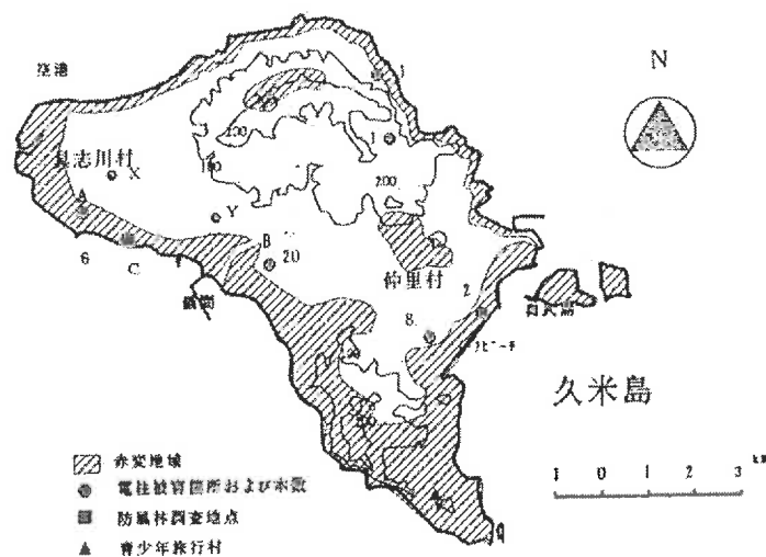
図-2 赤変状況、調査地点および電柱被害箇所
