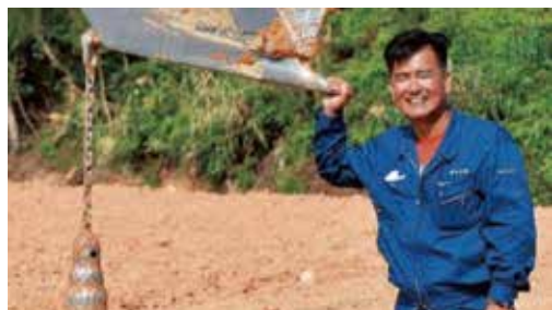
1 リッパーは掘削と同時に地中に円形の水路を形成可能
