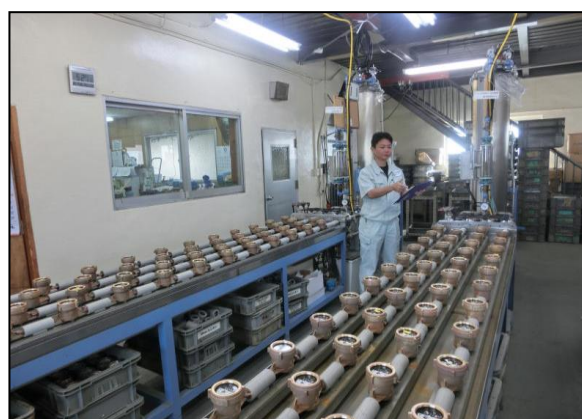
水道メーター検定の様子
