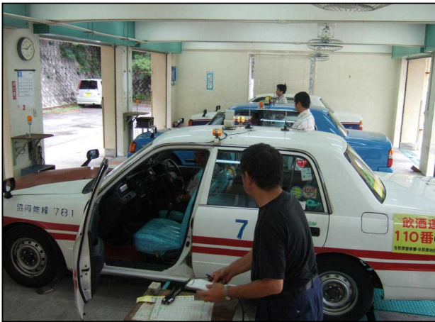
タクシメーター装置検査の様子
