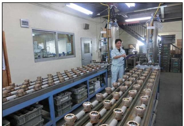
水道メーター検定の様子
