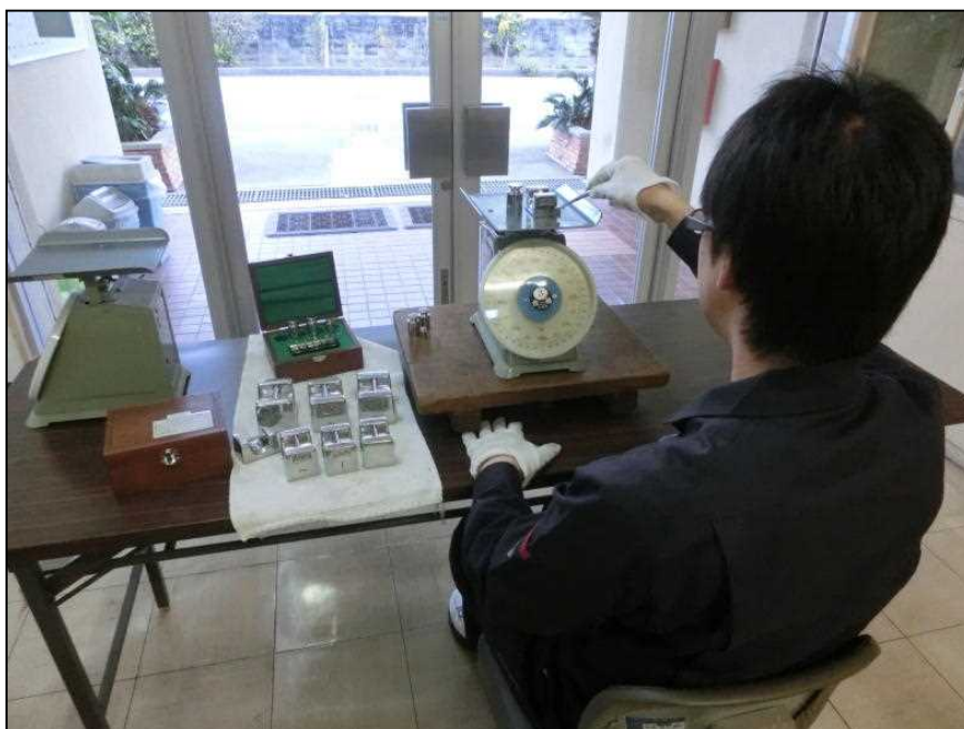
はかり定期検査の様子
