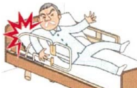
（手すり自体の隙間）
